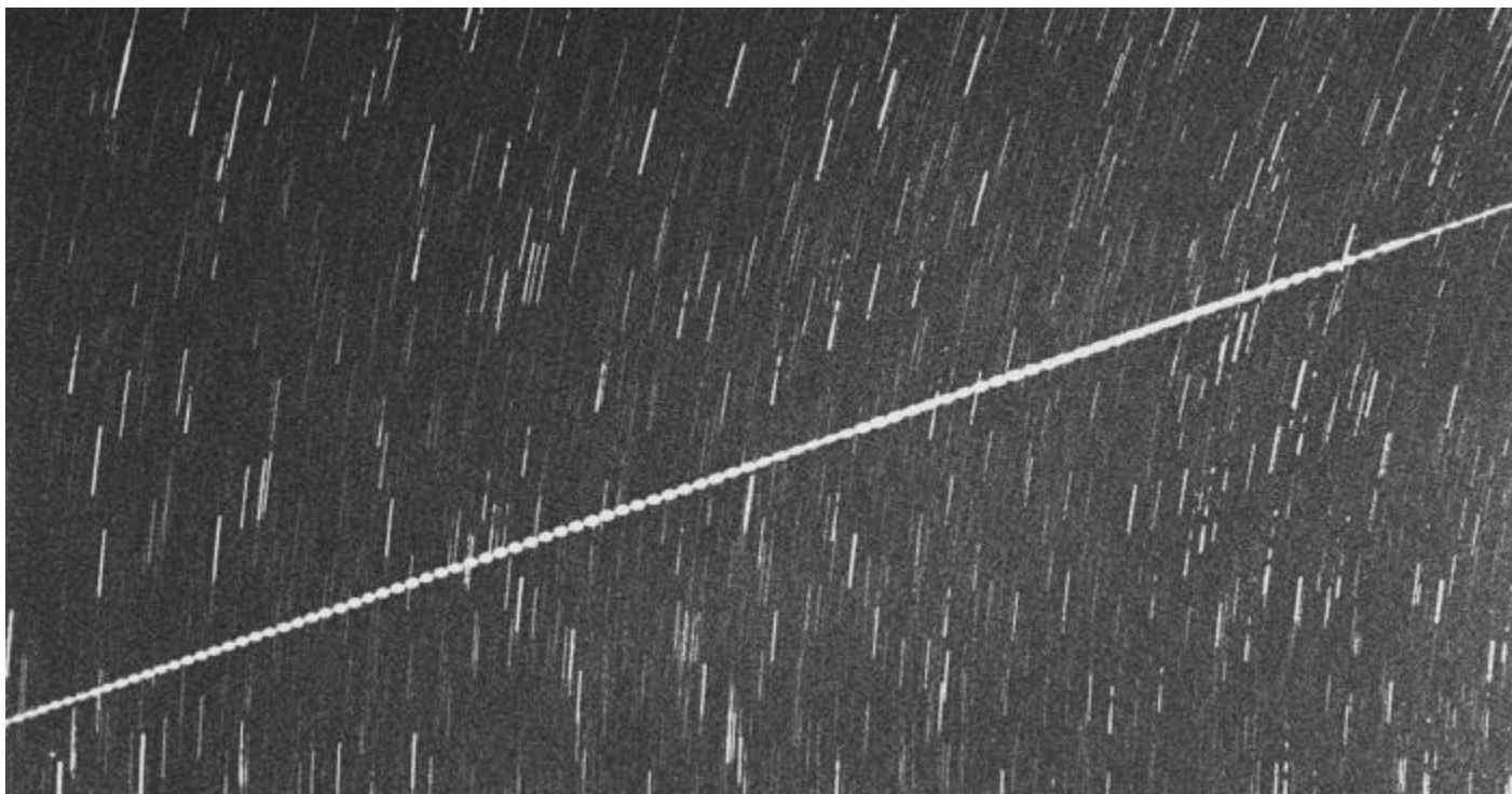
Figuur 2 : De sporadische meteor van 13 augustus 23h35m40s UT in een veel-motige opname vanuit Kunak. De meteor trok zijn spoor over drie negatieven van de lage, midden en hoge batterij. Ruim 150 onderbrekingen laten de Kunak component van een trimultaanopname met Telc en Ondjov zien.
